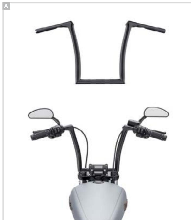
(注)ハンドルバーの交換により車検証に記載されている寸法より全高で±4cm、全幅±2cmの範囲を超える場合は、構造変更検査を受ける必要があります。
